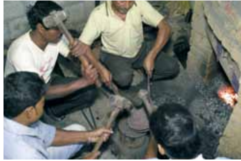
Beim Schmieden der Klangschalen sind Kraft und Ausdauer gefragt. Vier Männer treiben aus einem Metallrohling die Form einer Klangschale. Dann erst folgen Feinarbeiten. Bis eine traditionelle Klangschale fertig gestellt ist vergehen 4 bis 5 Stunden.
